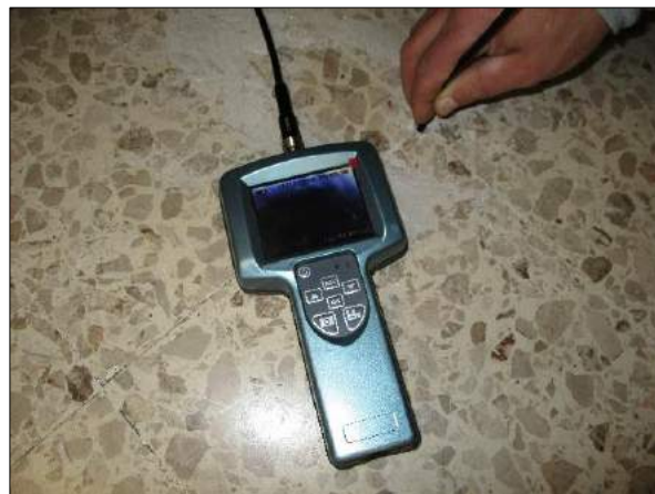
Foto 9 – Analisi endoscopica condotta all'estradosso del solaio.
