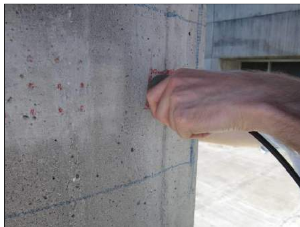
Foto 6-7 – Analisi ultrasonica diretta eseguita su un pilastro.
