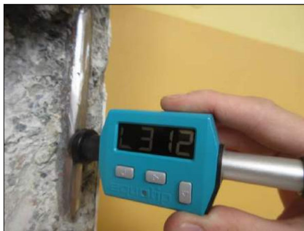
Foto 4 – Prova durometrica su barra di armatura.
