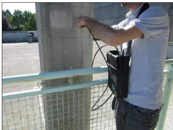
Foto 6-7 – Analisi ultrasonica diretta eseguita su un pilastro.
