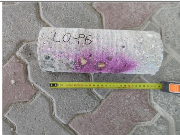
Analisi della profondità di carbonatazione eseguita sul campione di calcestruzzo prelevato dal pilastro 55 al piano terra.
