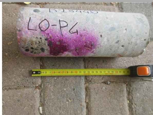
Analisi della profondità di carbonatazione eseguita sul campione di calcestruzzo prelevato dal pilastro 41 al piano terra.
