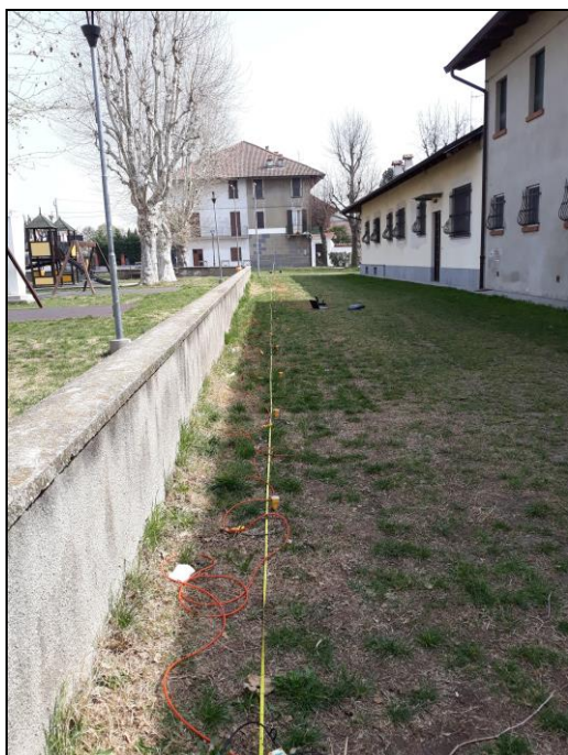
Foto n°1 – Stesa sismica M.A.S.W.
