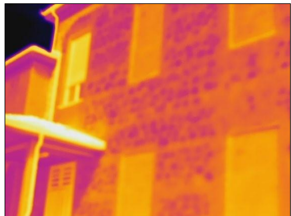
Foto n°9 - Analisi termografica che mostra l'assenza di un cordolo tra piano terra e piano primo.
