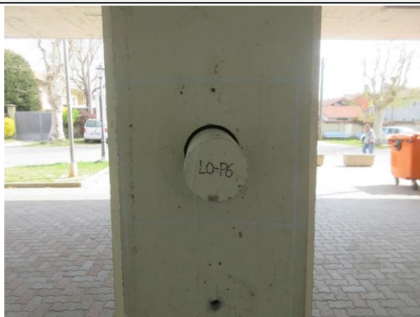
Pacometria e prelievo campione calcestruzzo eseguite sul pilastro 55 al piano terra.
